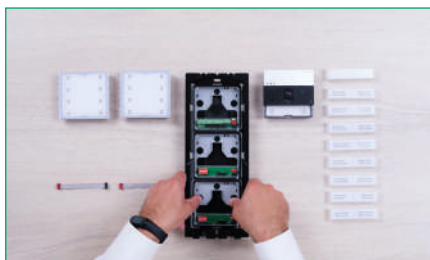
2. VERWIJDER het afdekframe en plaats de modules via het snelkoppelingssysteem
