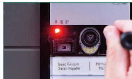
9. MET DE speciale schakelaar gaat u naar de programmeringsmodus (de invoer van de programmering wordt gesignaleerd door het oplichten van de betreffende led ) en selecteer MET DE dipswitches het eerste adres dat u aan de eerste drukknop wilt toekennen
