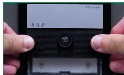
7. BEVESTIG: de audio/videomodule, de drukknopmodules en de naamkaders
