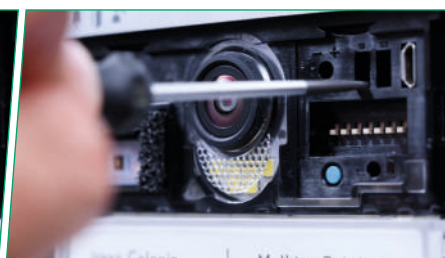
11. PLAATS de dipswitches in de oorspronkelijke configuratie en VERLAAT de programmeringsmodus (het verlaten van de programmering wordt gesignaleerd door het doven van de betreffende led)
