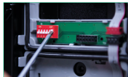
6. CONFIGUREER het type drukknop dat gebruikt gaat worden (enkel/dubbel) en een adres voor de drukknopmodule
