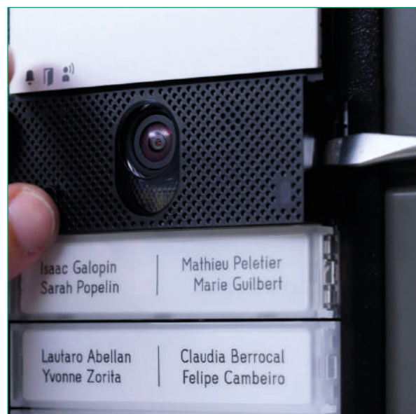
8. VERWIJDER de frontplaat om naar de diverse programmeringen/afstellingen te gaan
