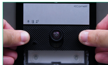
7. ACCROCHER : le module audio/vidéo, les modules de boutons et les étiquettes porte-noms
