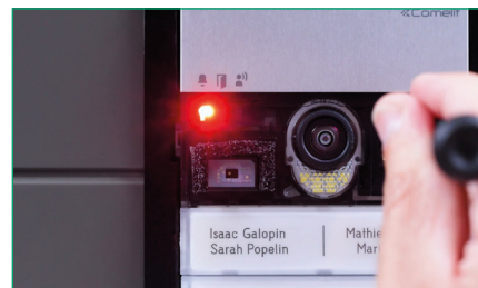
9. À L'AIDE du sélecteur dédié, entrer en mode programmation (l'entrée en programmation est indiquée par l'allumage de la LED dédiée) et À L'AIDE du dip switch, sélectionner la première adresse à attribuer au premier bouton
